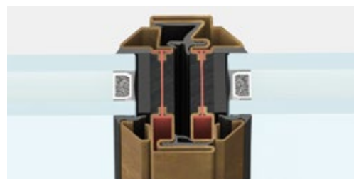
nodo centrale | sezione in vista 62 mm
