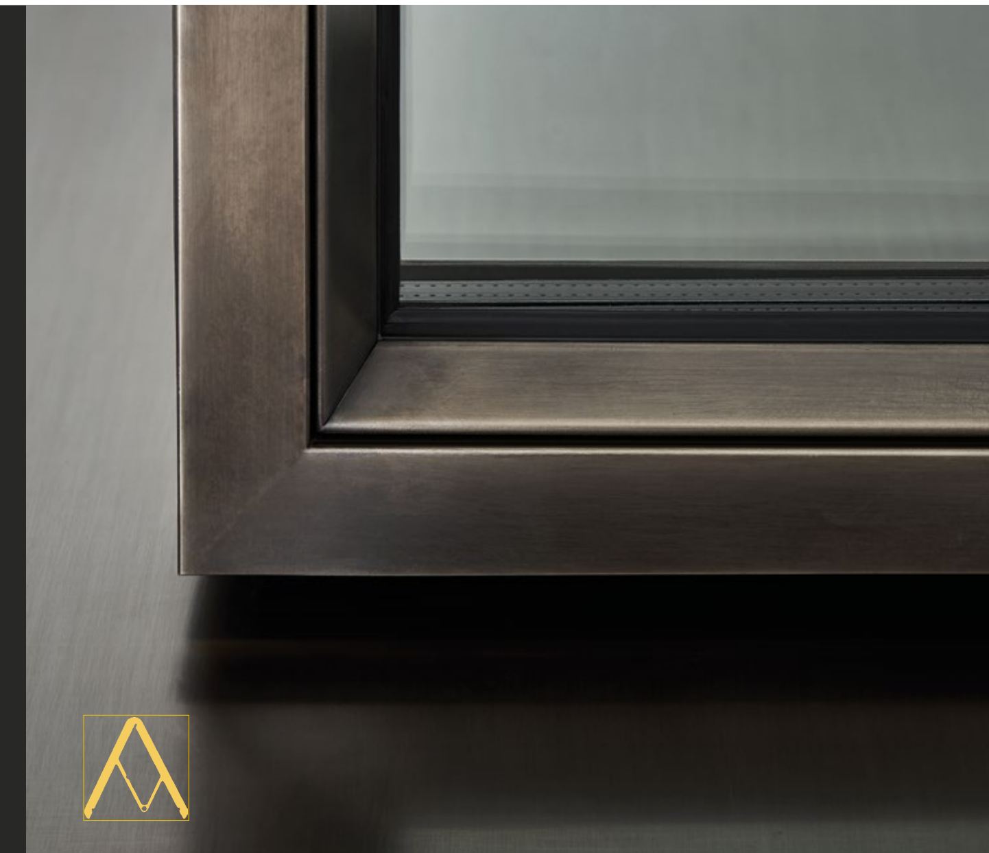
Angolo finestra OS2 75 vista interna in acciaio inox brunito con fermavetro triangolare e cerniere a scomparsa.
