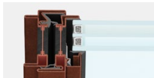
nodo laterale superiore | sezione in vista 62 mm
