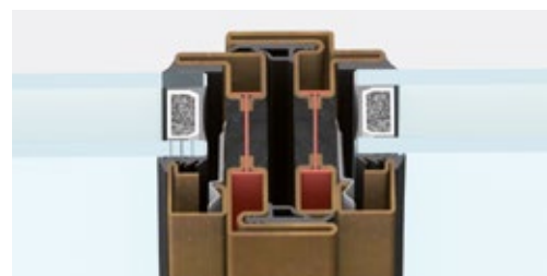
nodo centrale | sezione in vista 62 mm
