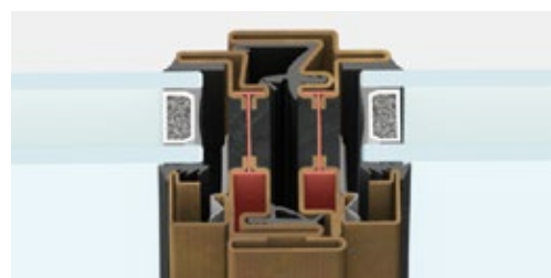
nodo centrale | sezione in vista 62 mm
