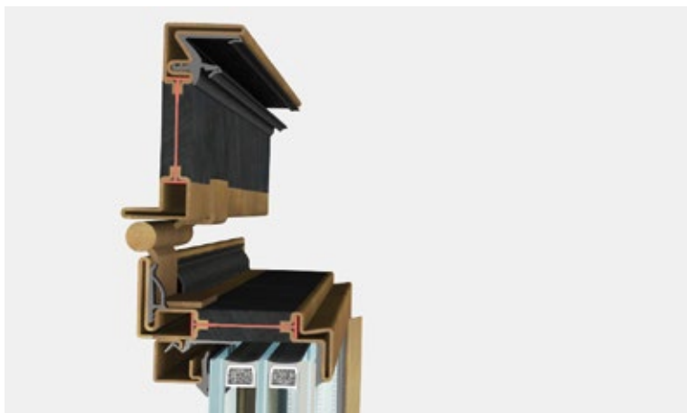
nodo laterale | sezione in vista 47 mm
