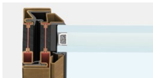
nodo laterale | sezione in vista 47 mm
