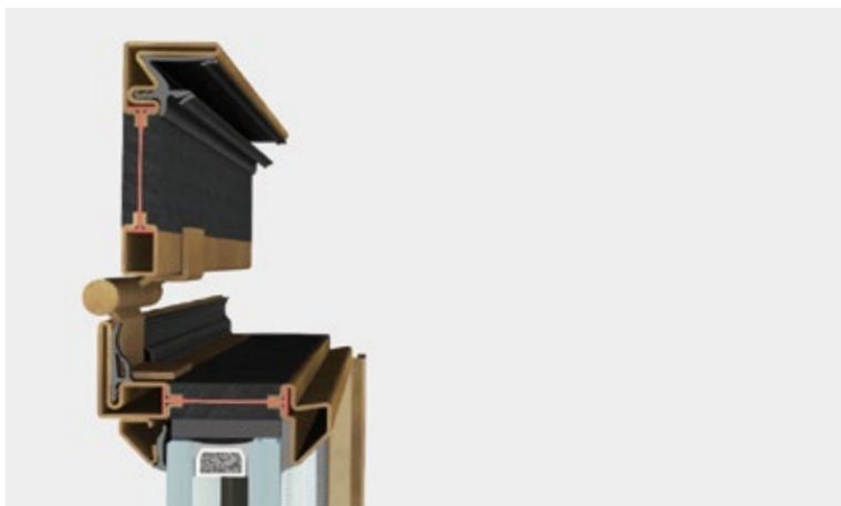
nodo laterale | sezione in vista 47 mm
