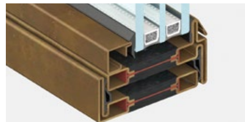
nodo inferiore | sezione in vista 47 mm
