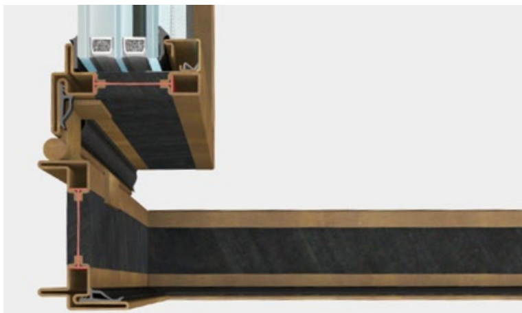
nodo inferiore | sezione in vista 47 mm
