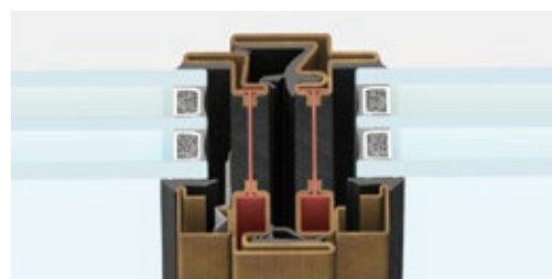
nodo centrale | sezione in vista 62 mm
