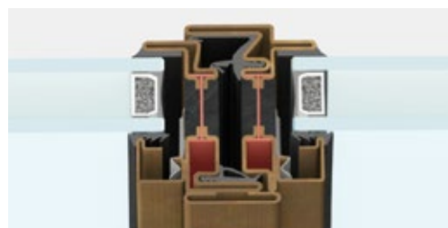
nodo centrale | sezione in vista 62 mm
