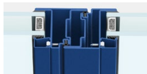
nodo centrale | complanare | sezione in vista 101 mm
