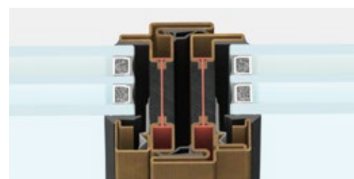
nodo centrale | sezione in vista 62 mm
