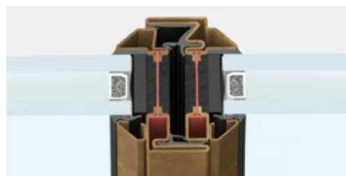
nodo centrale | sezione in vista 62 mm
