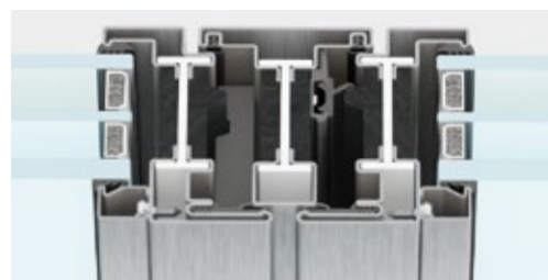
nodo centrale | sezione in vista 145 mm
