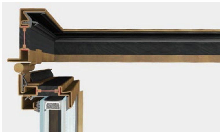
nodo inferiore | sezione in vista 47 mm
