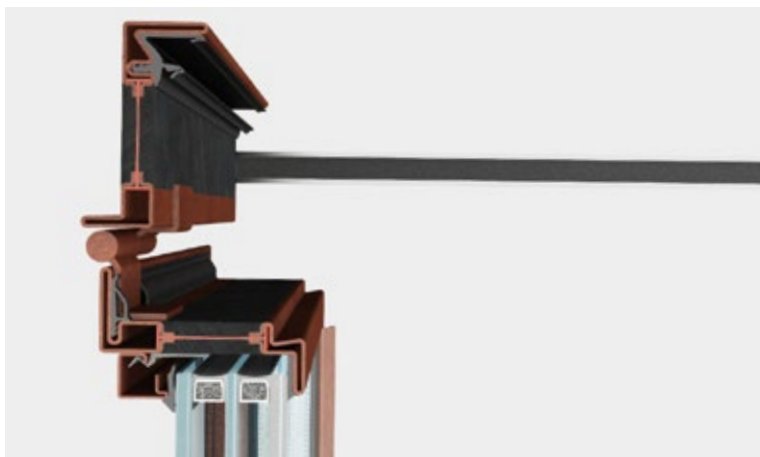
nodo centrale | sezione in vista 62 mm
