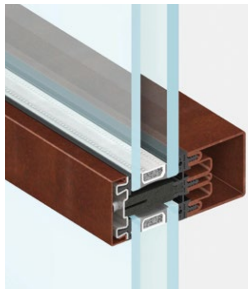
montante/traverso | sezione in vista 50 mm
