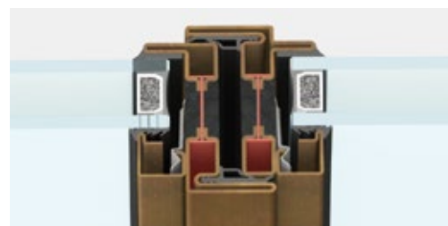
nodo centrale | sezione in vista 62 mm
