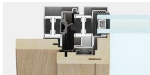
nodo laterale | sezione in vista 85 mm
