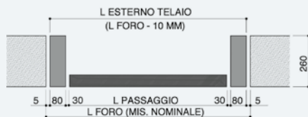
POSIZIONE IN LUCE STRUTTURA SPAZIO HF
