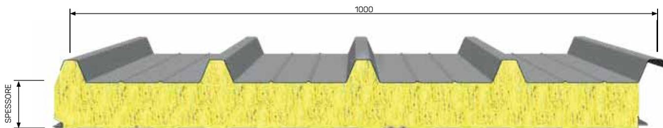
Pannello sandwich a doppio rivestimento metallico, per coperture con pendenza non inferiore a 7%, coibentato in **lana minerale di vetro**, con lamiera esterna profilata a 5 greche. Il fissaggio è di tipo a vista, con appositi cappellotti metallici con guarnizione.
