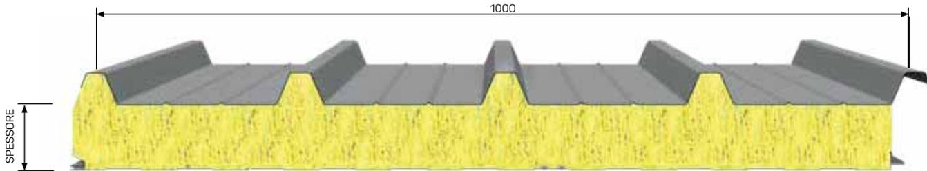
Pannello sandwich a doppio rivestimento metallico, per coperture con pendenza non inferiore a 7%, coibentato in **lana minerale di vetro**, con lamiera esterna profilata a 5 greche. Il fissaggio è di tipo a vista, con appositi cappellotti metallici con guarnizione. Possiede un supporto interno costituito da una lamiera microforata in grado di aumentare le prestazioni di fonoassorbimento del pannello.
