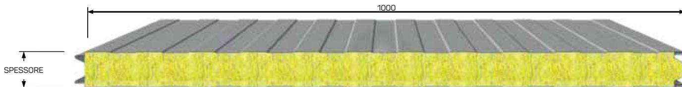
Pannello da parete a doppio rivestimento metallico con isolamento in **lana minerale di vetro**. Il giunto, con incastri maschio-femmina, è di tipo a vista con vite passante. Possiede un supporto interno costituito da una lamiera microforata in grado di aumentare le prestazioni di fonoassorbimento del pannello.
