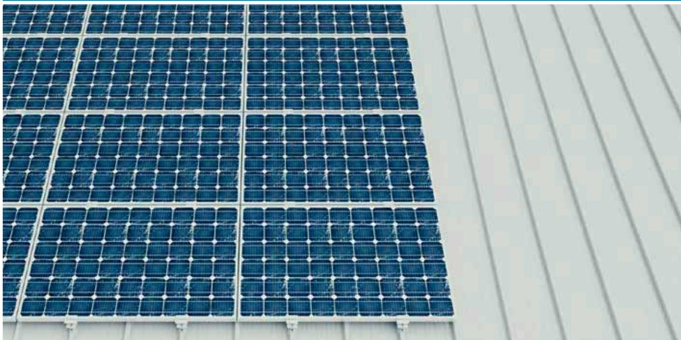
Pannello sandwich a doppio rivestimento metallico, per coperture con pendenza non inferiore a 7%, coibentato in poliuretano, con lamiera esterna profilata a 4 greche. Il fissaggio è a vista, con apposito cappello con guarnizione. Grazie alla conformazione della greca a coda di rondine, è possibile integrare la copertura con appositi accessori.
