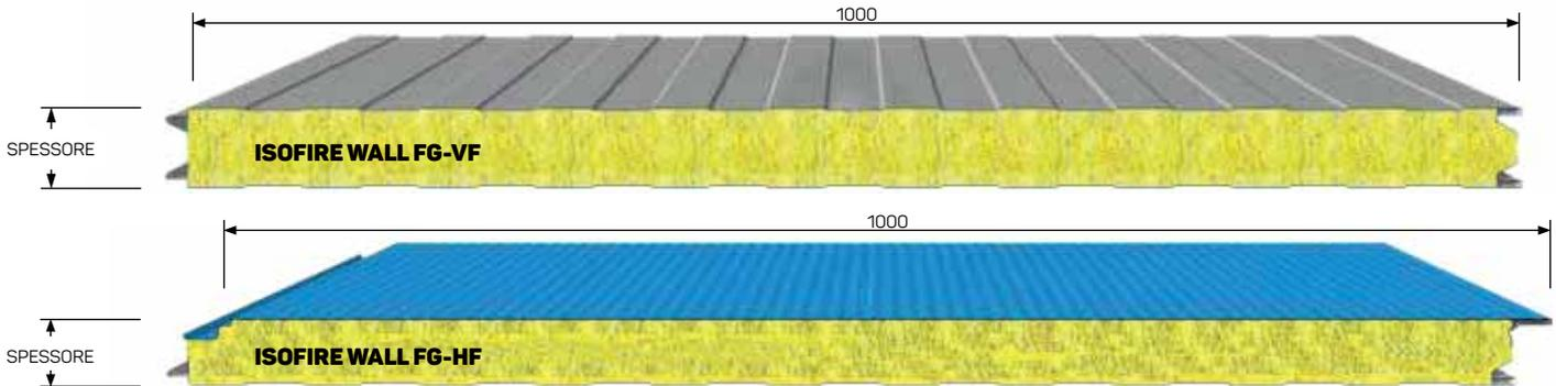
Pannello da parete a doppio rivestimento metallico con isolamento in **lana minerale di vetro**. Il giunto, con incastri maschio-femmina, è di tipo a vista (Isofire Wall FG-VF), oppure nascosto (Isofire Wall FG-HF), con vite passante.
