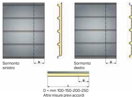
**ISOLAMENTO TERMICO****In accordo con EN 14509 A.10**
